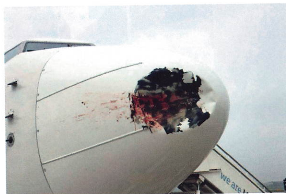
Uszkodzenia po kolizji z ptakiem oraz z losiem
